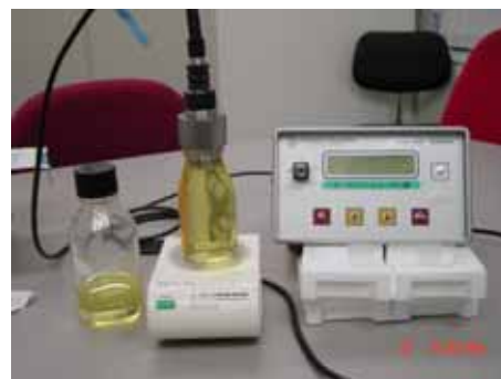
ラボユースでの溶存酸素測定例
