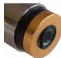
4) 新しいO-リングを取り付けて完了
